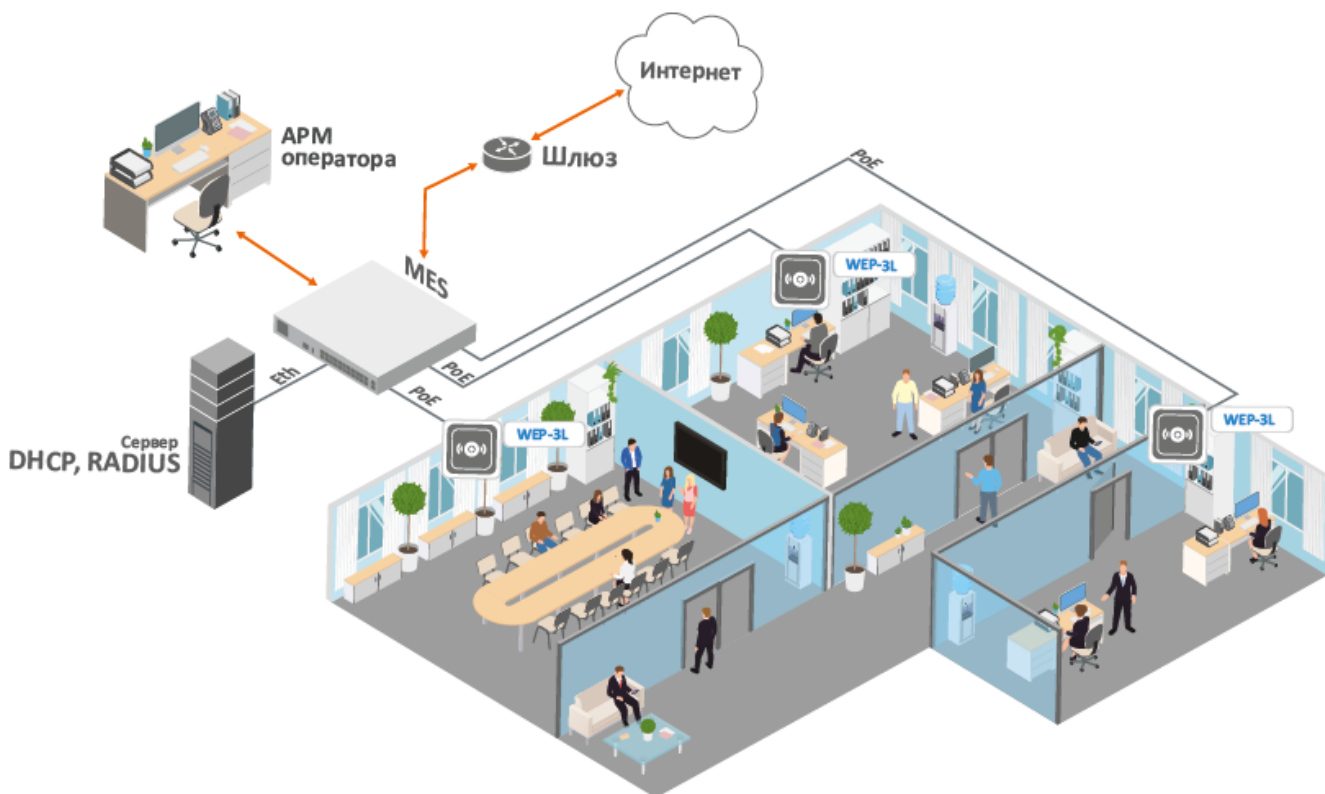
Рисунок 1 – Функциональная схема использования WEP-3L
