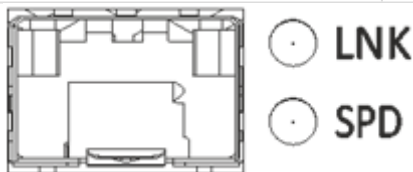
Рисунок 65 – Расположение индикаторов разъема SFP
