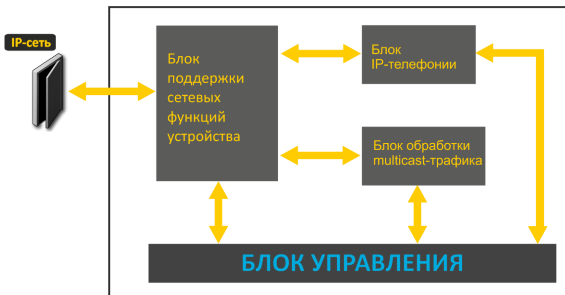
Рисунок 3 — Функциональная схема устройства серии TAU-1M.IP
