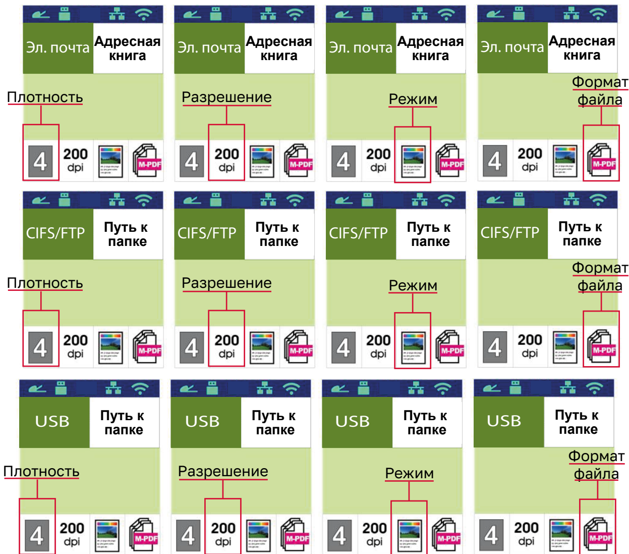
Рисунок 39 – Выбор параметров сканирования для каждого режима
