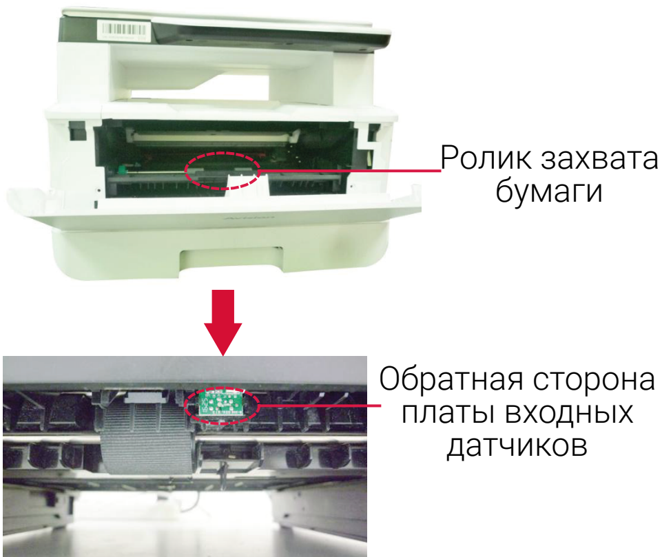
Рисунок 41 – Очистка входных датчиков бумаги
