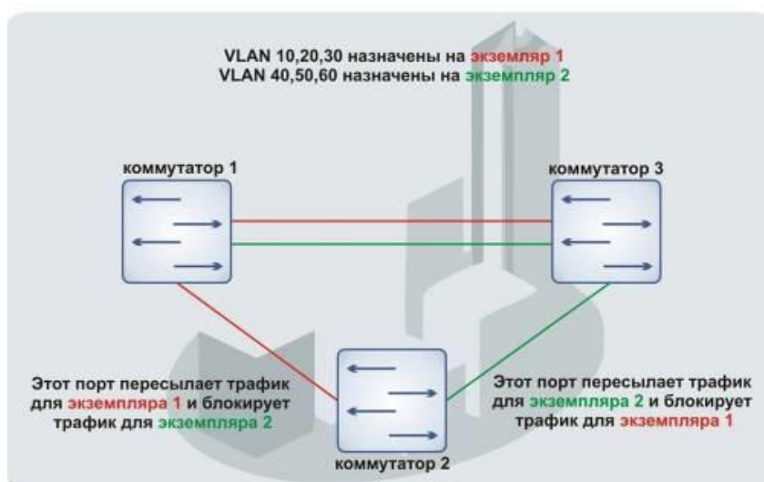
Рисунок А.1 — Настройка протокола множества связующих деревьев
