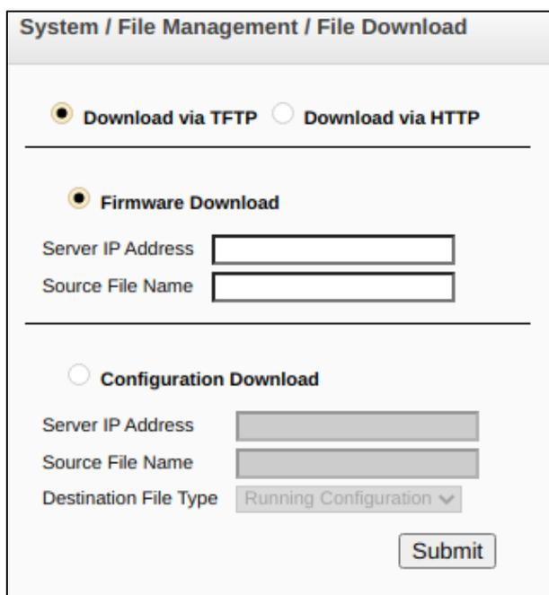
Загрузить файл ПО через web-браузер возможно двумя способами: с использованием сервера TFTP или с использованием сервера HTTP.
